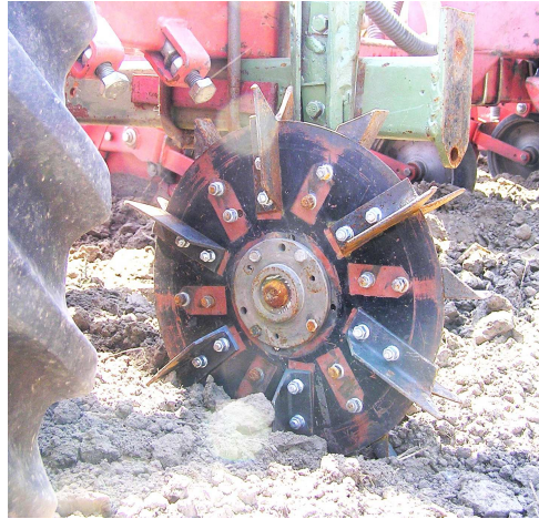
Рис. 1. Загальний вигляд експериментального зубчастого прорізуючого робочого органу
