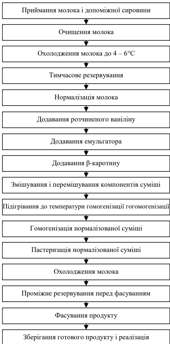
Рис. 1. Технологічна схема виробництва розробленого продукту
