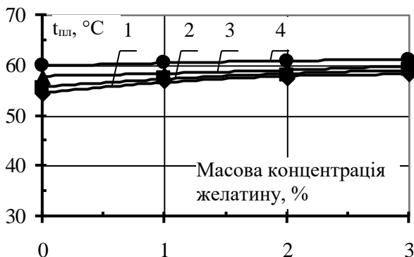
Рис. 4. Залежність температури плавлення змішаних гелів від масової концентрації желатину за молярної концентрації калію виннокислого 0,02 моль/л та вмісту фуруцелларану: 1 – 1,0%, 2 – 1,5%, 3 – 2,0%, 4 – 2,5%.
