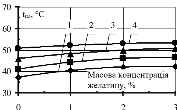
Рис. 1. Залежність температури плавлення змішаних гелів від масової концентрації желатину за вмісту фурицелларану: 1 – 1,0%, 2 – 1,5%, 3 – 2,0%, 4 – 2,5%.
