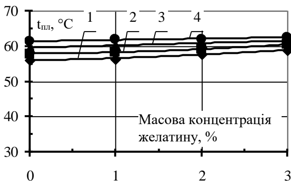
Рис. 5. Залежність температури плавлення змішаних гелів від масової концентрації желатину за молярної концентрації калію виннокислого 0,03 моль/л та вмісту фуруцелларану: 1 – 1,0%, 2 – 1,5%, 3 – 2,0%, 4 – 2,5%.
