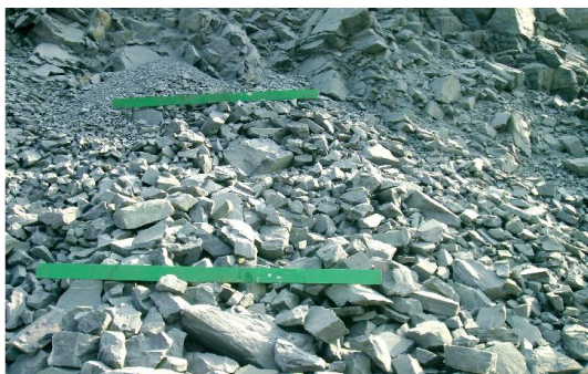
Рис. 1. Снимок взорванной горной массы при взрывании ВВ типа Украинит ПП-2 в карьере ОАО «ЮГОКа» в 2008 г., блок №76 гор. -45/-60 м
