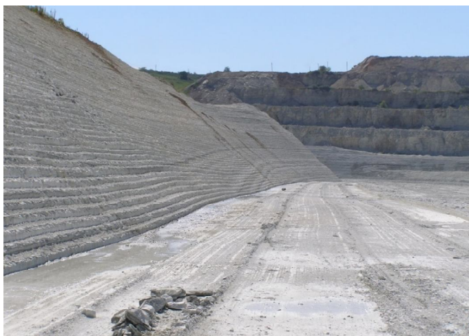
Рис. 1. Укiс уступу після відпрацювання кар'єрним комбайном фрезерного типу
