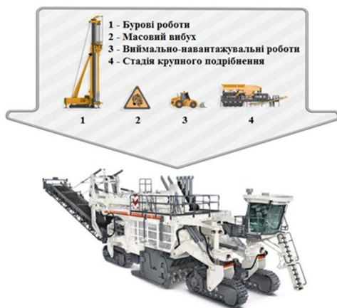
Рис. 2. Комплекс робіт, котрі можна замінити застосуванням комбайна фрезерного типу
