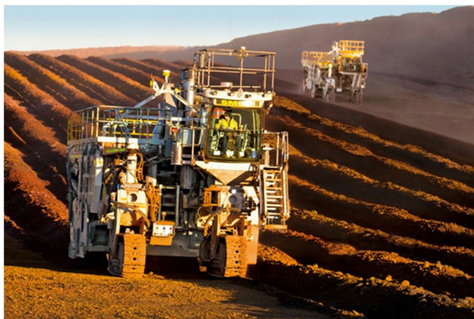
Рис. 4. Видобуток залізної руди в кар'єрі Down Under (Австралії) з укладанням її в штабель (по матеріалам Wirtgen Group)
