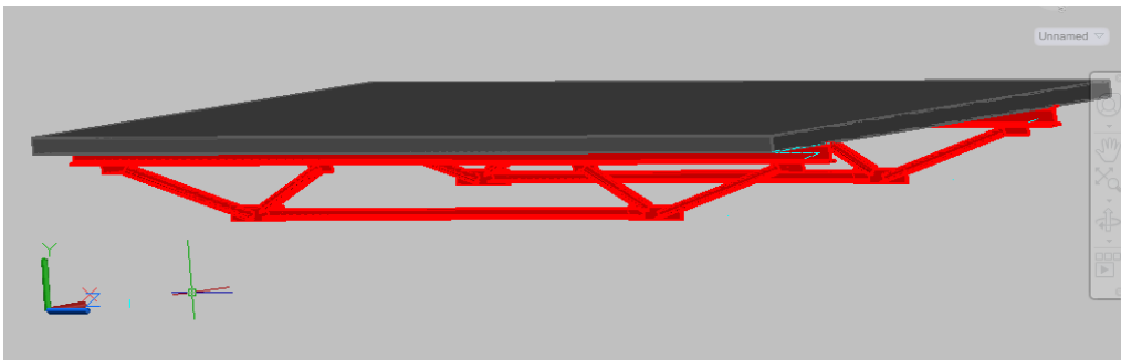
Рис. 1. Модель просторової комбінованої сталезалізобетонної шпренгельної конструкції.
