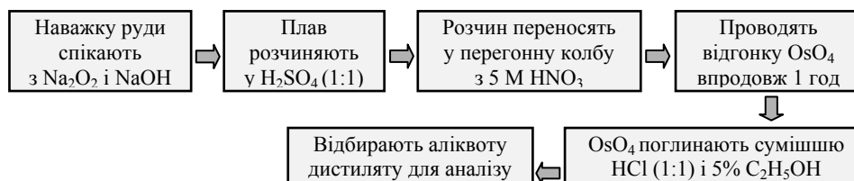
Рис. 1. Схема класичної пробопідготовки руди для визначення осмію
