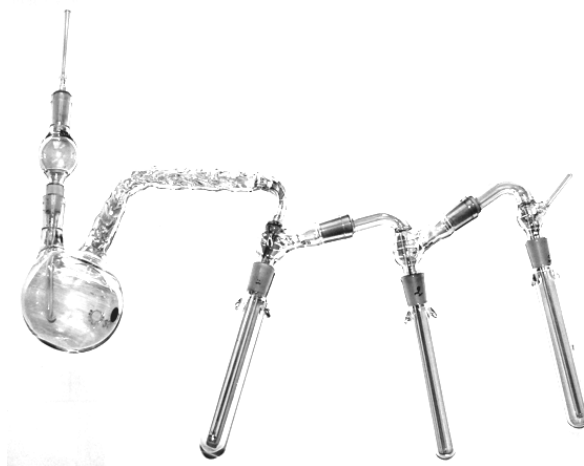
Рис. 2. Прилад для відгонки \text{OsO}_4
