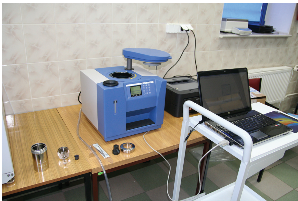
Rys.1. Widok systemu pomiarowego z kalorymetrem IKA C200, przy użyciu którego realizowano pomiary ciepła spalania
