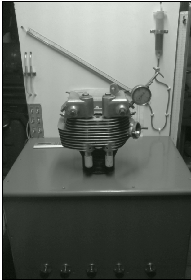
Rys. 2. Stanowisko pomiarowe „Flow Bench” wykorzystane do badań przepływowych kanałów 4-suwowych silników spalinowych (z zamontowaną głowicą silnika S03) [3]
