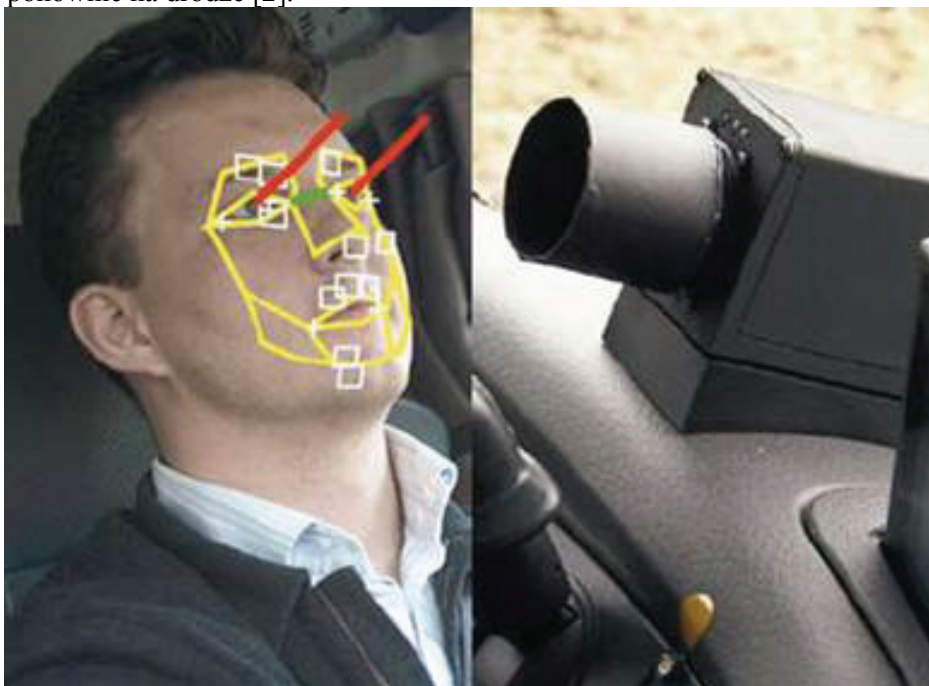
Rys. 5. Przykład działania systemu ostrzegania o zmęczeniu DDA [2]
