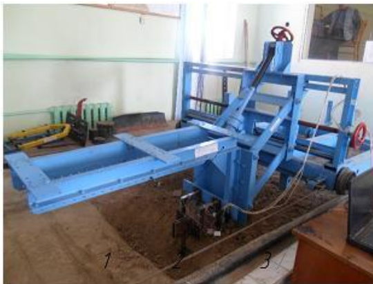
Рис. 2. Загальний вигляд ґрунтового каналу та тензометричного візка: 1 – тензометричний візок; 2 – плита кріплення для ножів; 3 – канатна тяга
