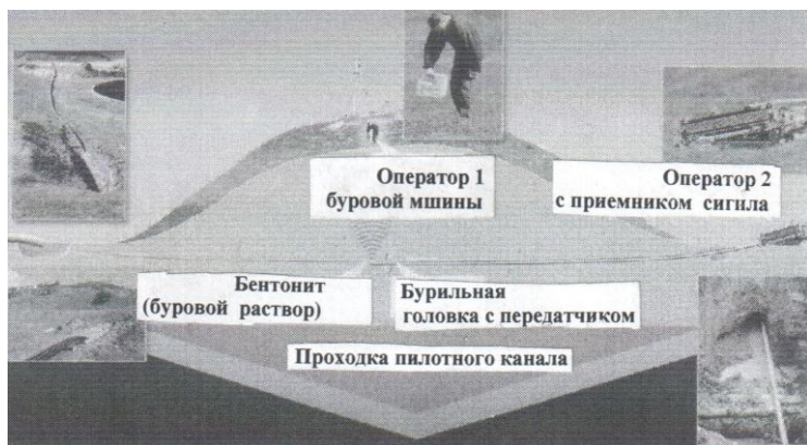
Рис.1. Первый этап горизонтального бурения
