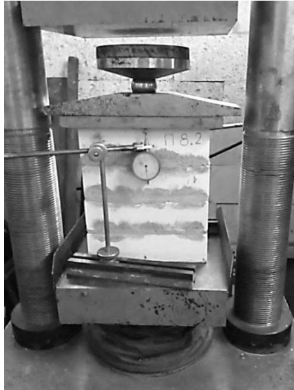
Фото 1. Схема испытаний опытных образцов – общий вид и схема расстановки приборов
