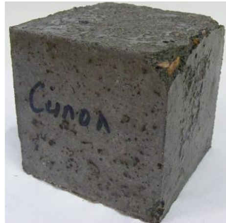
Рис. 2. Образец после 300 циклов испытаний
