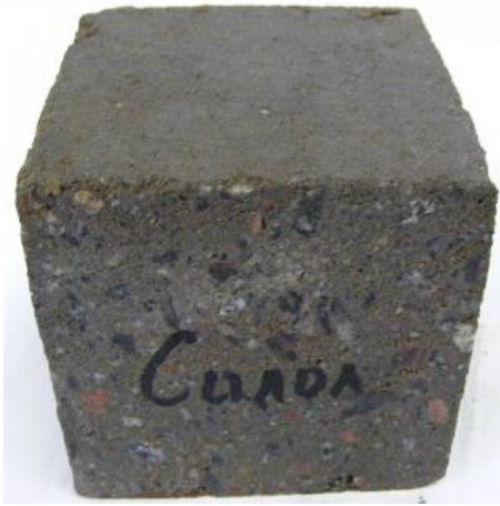
Рис. 1. Образец до 300 циклов испытаний
