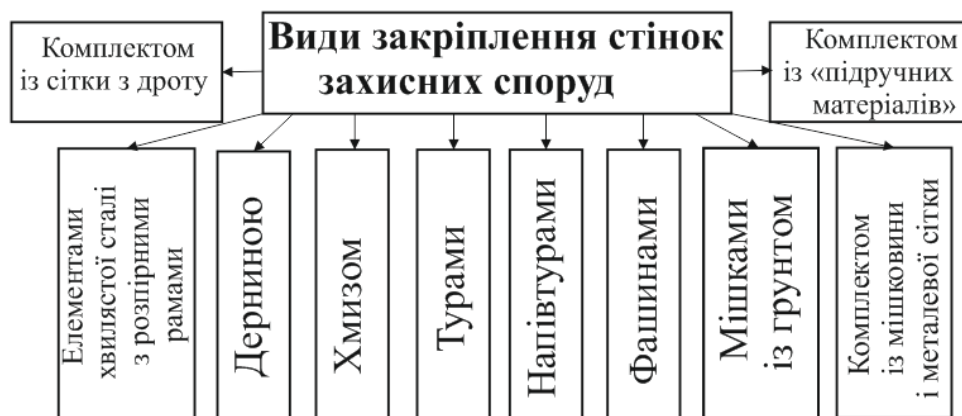
Рис. 1. Види закріплення стінок захисних споруд
