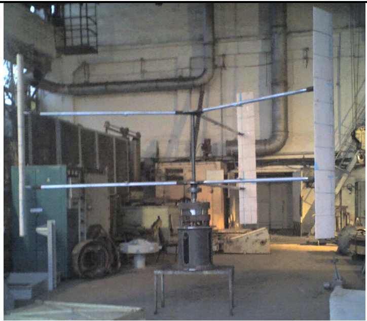
Рис.5. Экспериментальный образец автономной ВЭУ в цехе сборки
