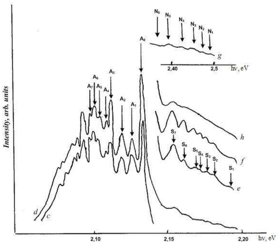
**Рис. 2.** Спектры фотолюминесценции при  $T = 4,2\text{K}$ : *c* – скол в плоскости  $[010]$ ; *d* – облученный в вакууме электронами  $\Phi_e = 3 \times 10^{14} \text{ см}^{-2}$ ; *e,f* – облученные электронами  $\Phi_e = 5 \times 10^{14} \text{ см}^{-2}$  и  $\Phi_e = 3 \times 10^{15} \text{ см}^{-2}$ ; *g* – после  $\gamma$ -облучения; *h* – после травления.
