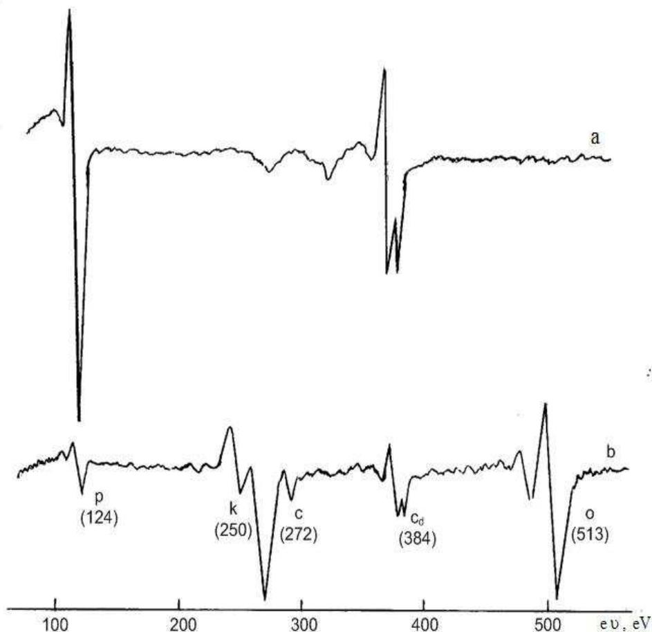
**Рис. 1. Оже-спектр поверхности  $CdP_2$ : а – свежий скол кристалла в направлении [010]; б – после длительной выдержки на воздухе и  $\gamma$ -облученный при  $T = 300$  К.**
