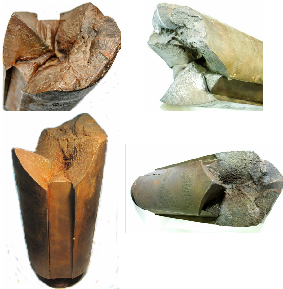
Рис. 3. Картина руйнування суднового вала в різних проекціях
