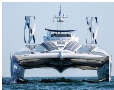
*Рис. 7. Катамаран Energy Observer на водородном топливе*
