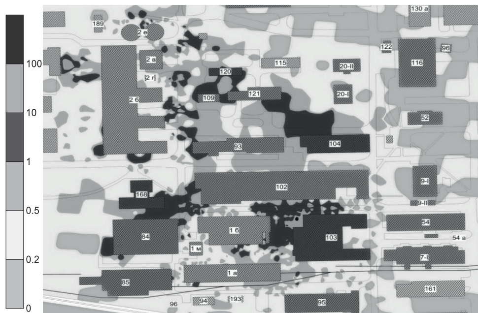
Рис. 2 – Фрагмент зйомки ПЕД гамма-випромінювання (мкЗв/год) на висоті 1 м від поверхні території в центральній частині південного сектору майданчика колишнього ВО «ПХЗ»
