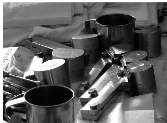
Рис. 6. Набір прес-форм для інтраопераційного виготовлення спейсерів кульшового суглоба
