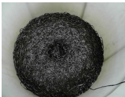
Рис. 6. Волокно, сформованное из композита ПЭТФ – 0,5 % УНТ
