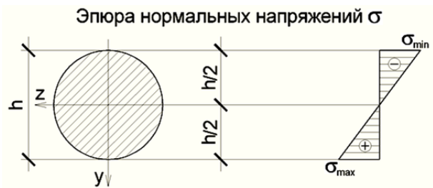
Рис. 5. Эпюра нормальных напряжений в поперечном сечении
