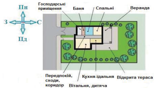
Рис. 1. Розташування будинку на ділянці по сторонах світу /Fig. 1. Location of the house in the area on the sides of the world
