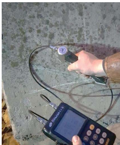
Рис. 4. Проведення вимірів із використанням ультразвукового приладу «Пульсар 1.1» / Fig. 4. Measurement using a Pulsar 1.1 ultrasonic device
