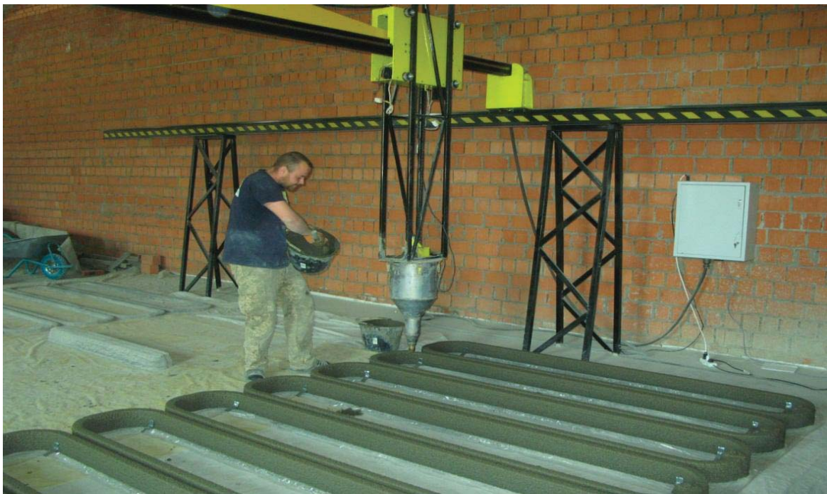
Рис. 1. Виготовлення секцій забору за допомогою 3D-принтера
