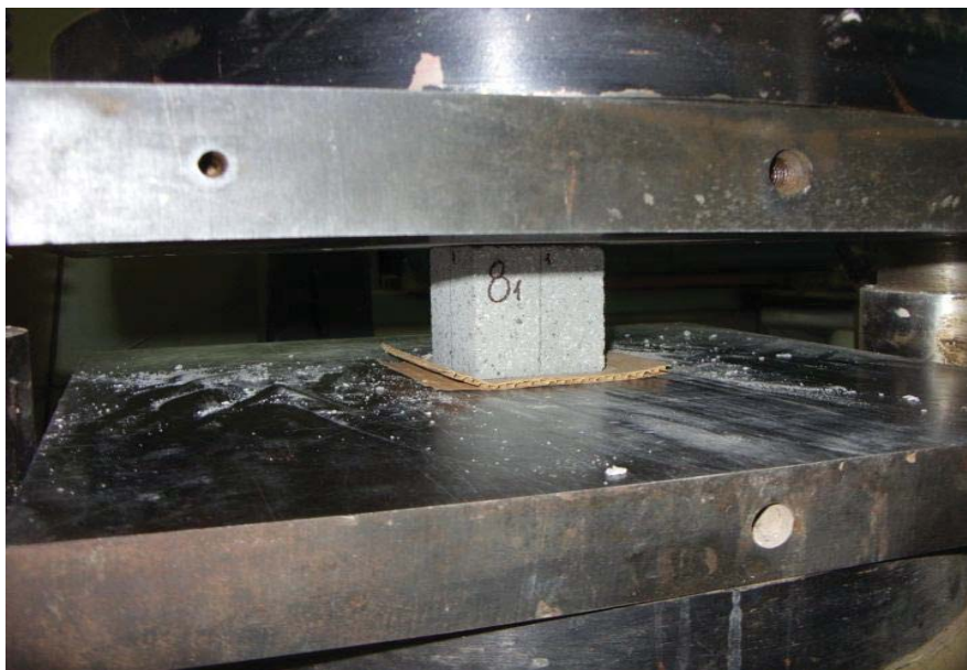
Рис. 2. Визначення міцності на стиск бетонних зразків розміром 100 \times 100 \times 100 мм на пресі П-125
