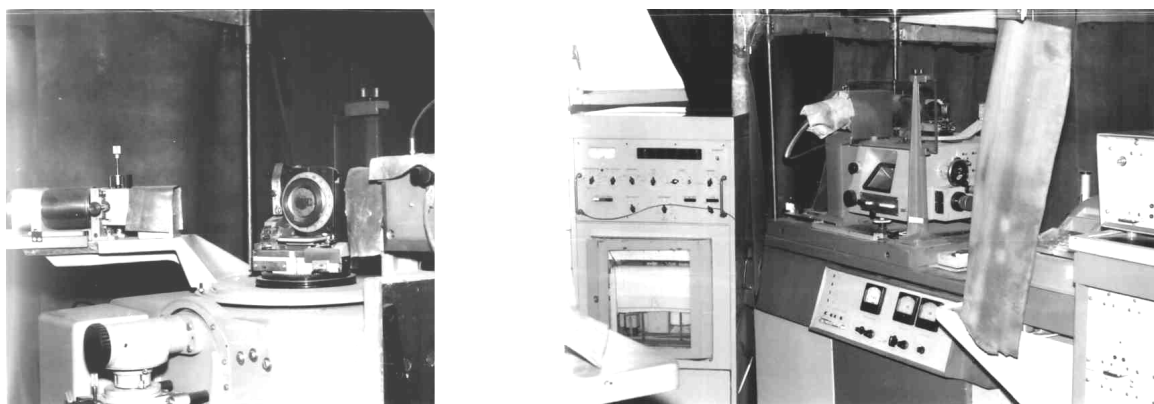
Рисунок 3 — Общий вид установки для рентгеноструктурного анализа
