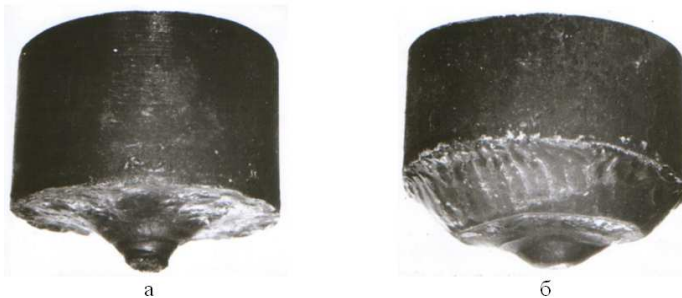
Рисунок 4 – Электродные торцы, полученные при ЭШП (а) и ЭШП+ДП (б)
