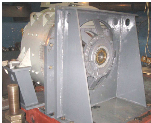
Рисунок 4 – Одноопорный генератор маневрового тепловоза ТЭМ 18ДМ на вибростенде
