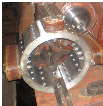
Рисунок 1 – Макет ротора главного и вспомогательного генератора магистрального тепловоза на вибростенде
