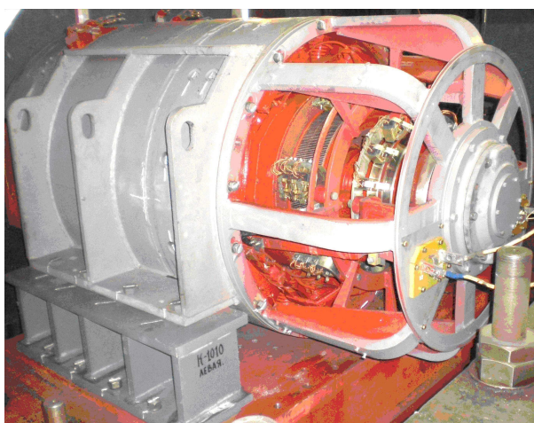
Рисунок 3 – Двухопорный тяговый агрегат магистрального тепловоза ТЭМ 9, установленный на вибростенд
