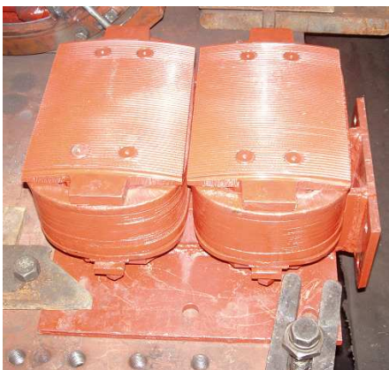
Рисунок 1 – Макет ротора главного и вспомогательного генератора магистрального тепловоза на вибростенде
