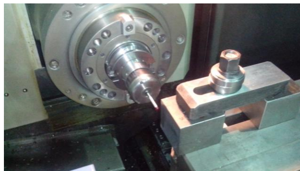
Рис. 2. Контроль результатів обробки деталі з використанням автоматичного вимірювального щупа
