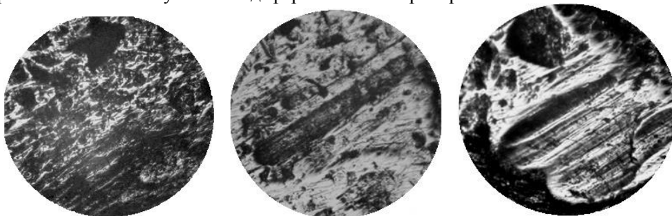
Рис. 3. Зношена поверхня матеріалу решіт ( \times 100 )
