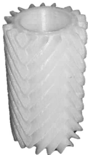
Рис. 2. Модель оболочки ТВЭЛа с шевронным оребрением, изготовленная на 3D-принтере
