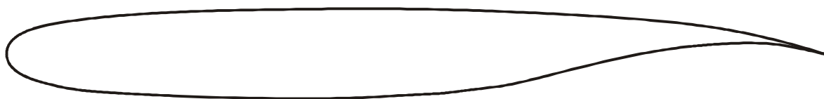
Рис. 1. Сверхкритический профиль McDonnell/Douglas DSMA-523 с острой задней кромкой
