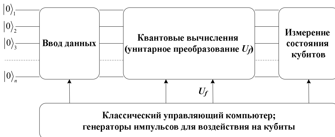
Рис. 1. Структурная схема квантового компьютера
