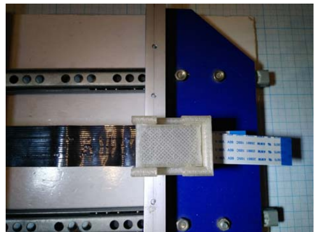
Рис. 8. Розміщення з'єднувача гнучких шлейфів
