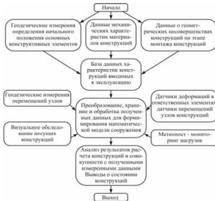
Рис. 5. Блок-схема выполнения расчета конструктивной схемы покрытия
