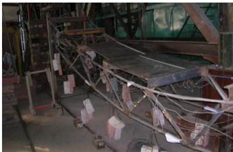
Рис. 11. Общий вид экспериментальной модели с ограждающей конструкцией из поликарбонатного пластика типа «Danpalon»
