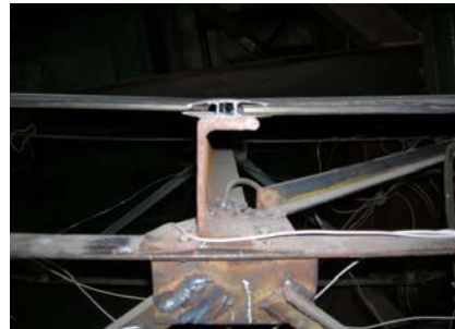
Рис. 12. Узел крепления пластика к несущей конструкции модели
