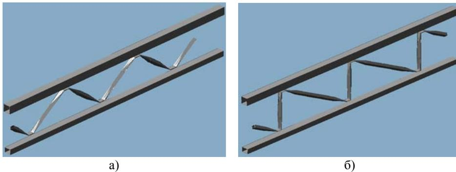
Рис. 2. Предлагаемое решение несущей конструкции с решеткой из ромбической трубы:
