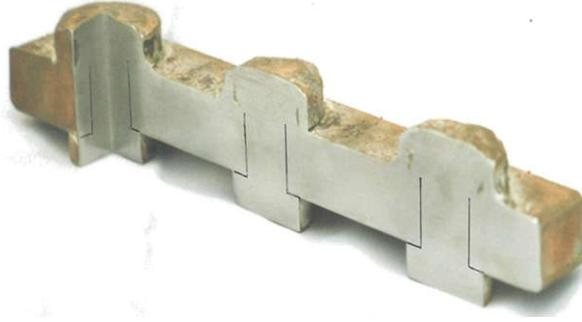
Рис. 11. Конструктивное решение восстановления замыкающей головки заклепок с использованием технологии постановки шайбы на электросварке. Фрагмент экспериментального образца модели заклепочного соединения
