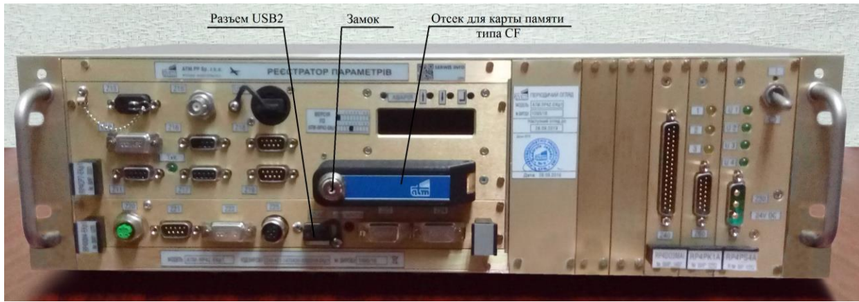
Рис. 7 - Приладовий блок реєстратора RP4Z-EKp1 (передня панель)
