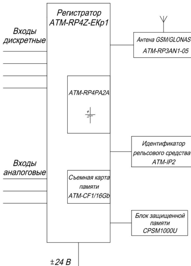
Рис. 6 - Структурна схема «Системи реєстрації параметрів АТМ-РР4Z-ЕКр1»
