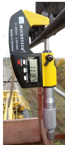
Мал. 1 – Фотографія заміру товщини контактного проводу, з фіксацією місця виконання заміру по GPS
