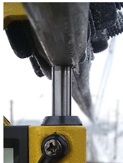
Мал. 1 – Фотографія заміру товщини контактного проводу, з фіксацією місця виконання заміру по GPS
