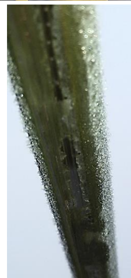
Мал. 2 – Контактний провід вкритий ожеледдю
