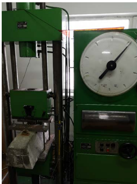
Рис. 5 – Використання розривної машини P-20 для проведення випробувань на виривання анкерів типу АЗ із бетону шпали
