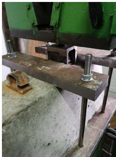
Рис. 5 – Використання розривної машини P-20 для проведення випробувань на виривання анкерів типу АЗ із бетону шпали
