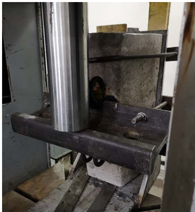
Рис. 8 – Визначення граничних горизонтальних зусиль, що передаються від рейки поздовж шпали до анкера, за допомогою гідравлічного пресу УСДІ-20 з гідравлічним пульсатором
