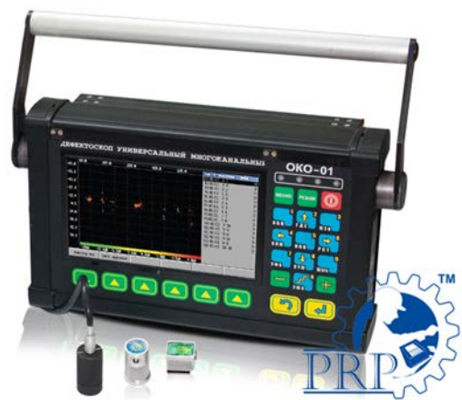
а) б) Рис. 2 – Вітчизняні ультразвукові дефектоскопи: а) УД4-76; б) УД4-94 «ОКО-01»
