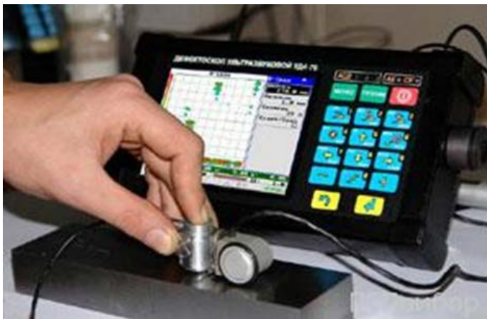
а) б) Рис. 2 – Вітчизняні ультразвукові дефектоскопи: а) УД4-76; б) УД4-94 «ОКО-01»
