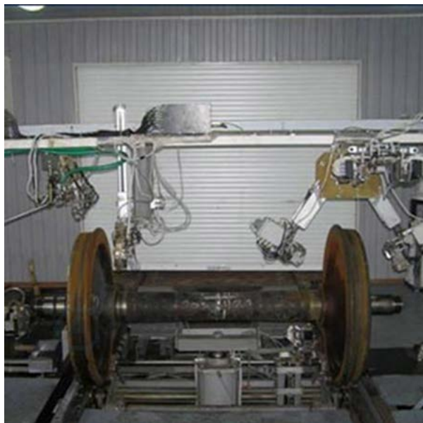
Рис. 3 - Автоматизована установка СНК КП-8.3 для комплексного неруйнівного контролю колісних пар вагонів
