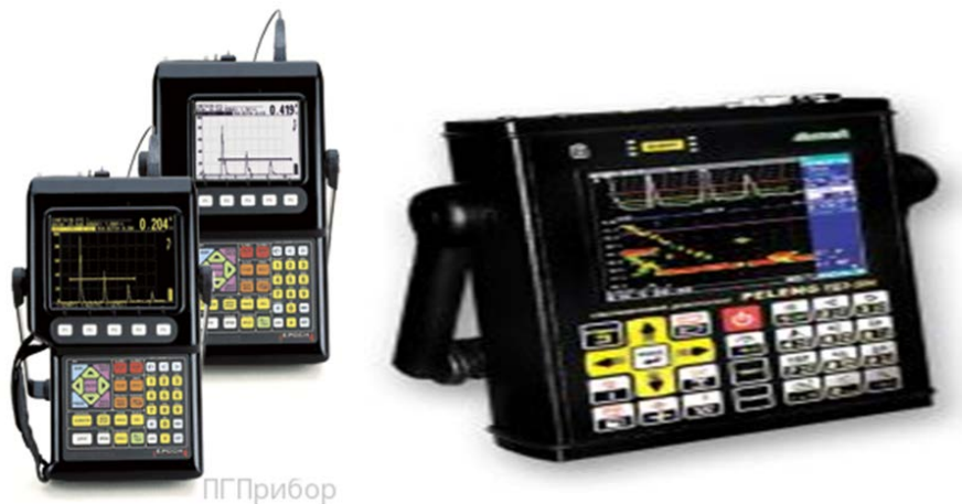
а) б) Рис. 1 – Іноземні ультразвукові дефектоскопи: а) EPOCH 4 (США); б) УДЗ-204 (РФ)
