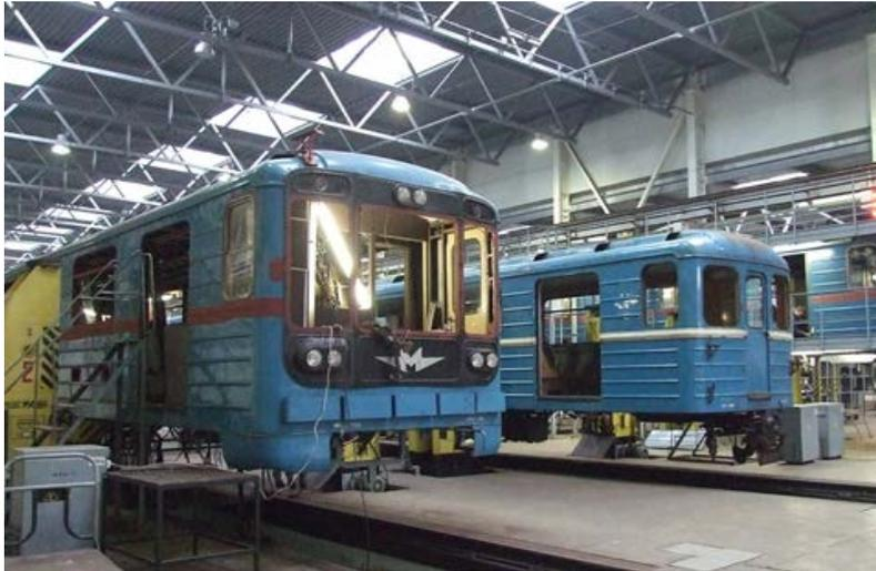
*Рис. 1 – Головной и промежуточный вагоны моделей 81-717 и 81-714*
