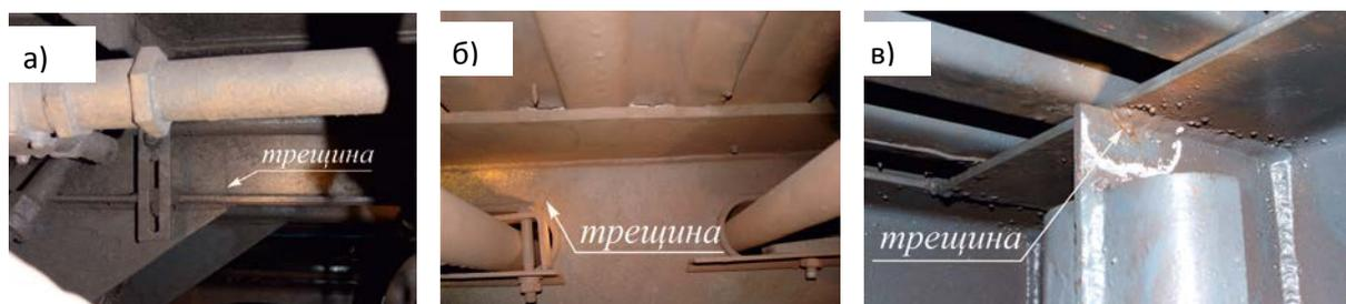
*Рис. 2 – Эксплуатационные повреждения элементов несущих конструкций вагонов моделей 81-717 и 81-714: а) – трещина в хребтовой балке в районе крепления сцепного устройства; б) – трещина в вертикальном листе шкворневой балки; в) – трещина кронштейна крепления подвески автосцепки*
