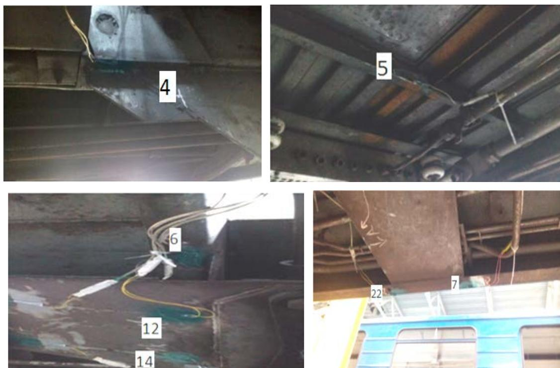
*Рис. 5 – Фрагменты расположения тензодатчиков на металлоконструкциях вагонов модели 81-717/714*
