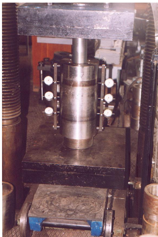
Рис. 1. Устройство для определения объемного модуля упругости эластомеров в испытательной машине ПР-500
