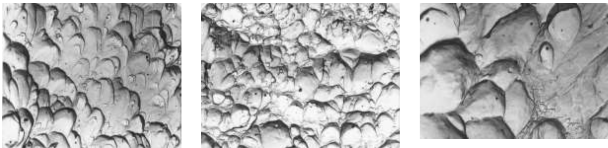
Рисунок 10 – Вязкое внутризеренное разрушение поверхностного слоя в средней части цилиндрического участка гребного вала (x3700)
