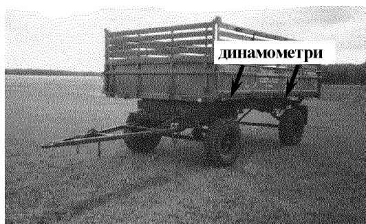
Рисунок 1 - Загальний вигляд і принципова схема універсальної вимірюваної системи для дослідження навантаженості мобільних машин
