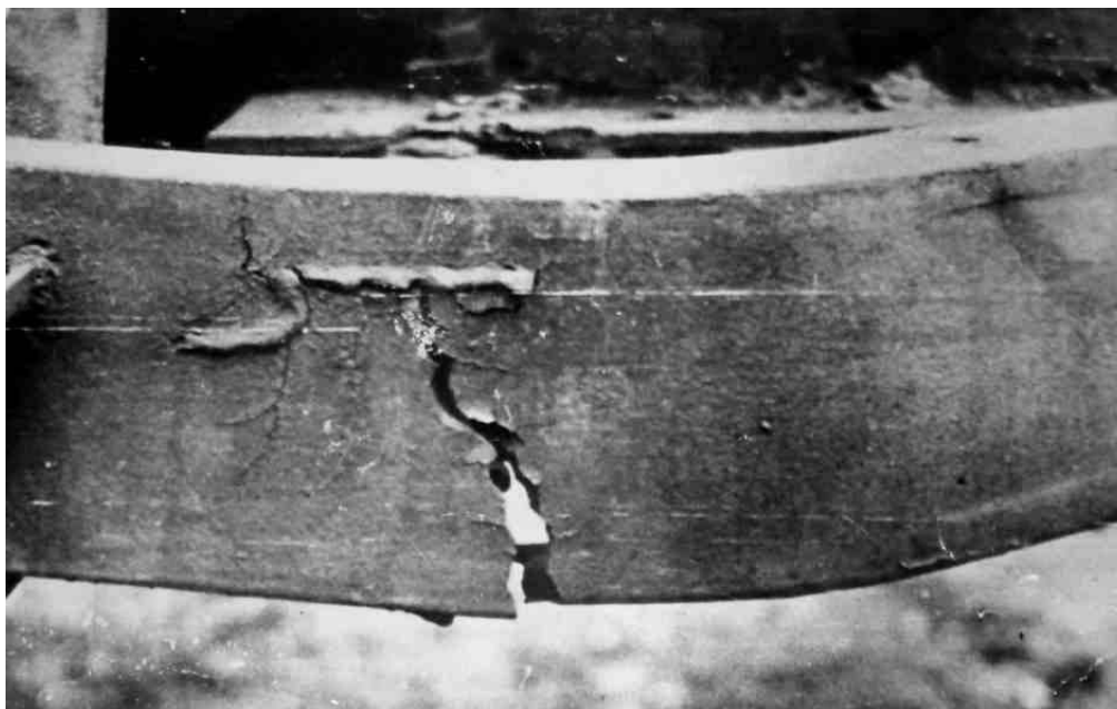
Рисунок 1 – Зруйнована рамна конструкція обприскувача сімейства ОВТ
