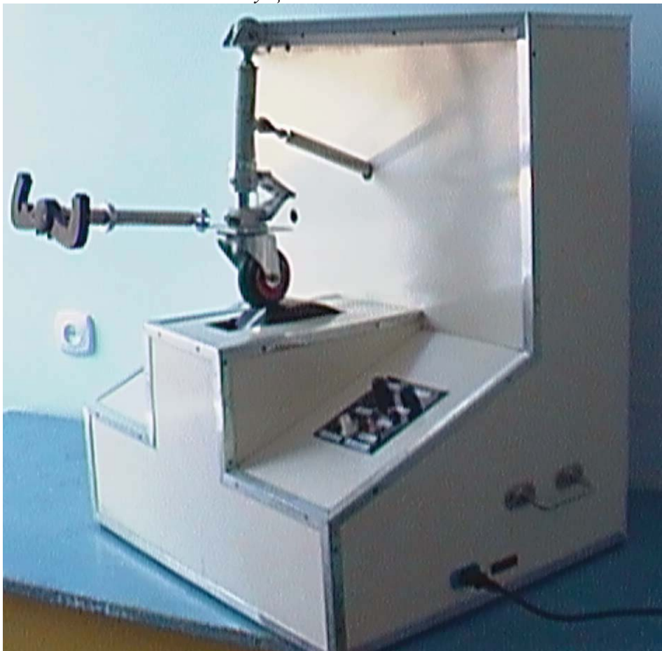
Рисунок 6 - Стенд для наблюдений поперечных колебаний подвески шасси
