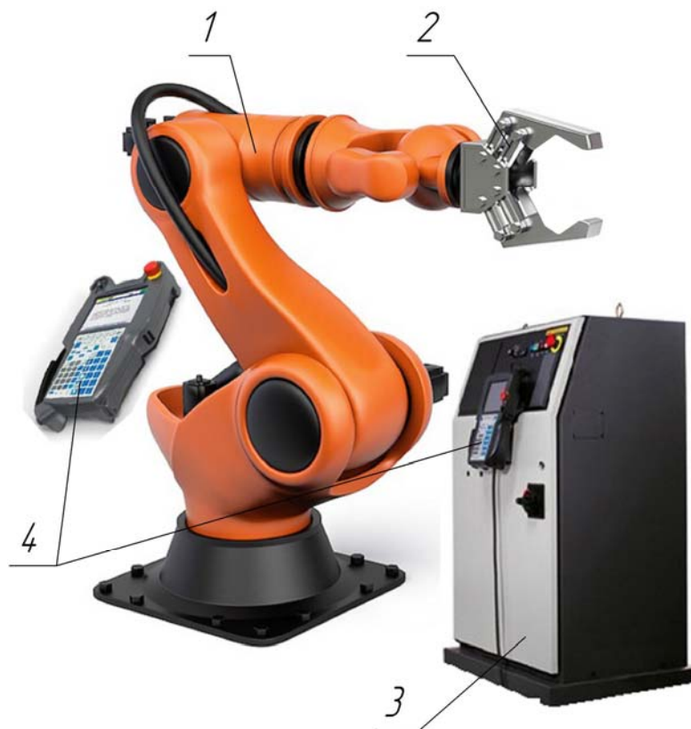
1 – виконавчий механізм; 2 – ЗП робота; 3 – блок управління; 4 – пульт управління
